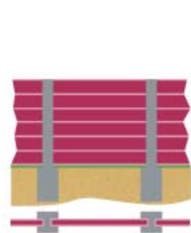
Grafik 15: Mobile Hochwasser-schutzwand aus Betonpfeilern und Dammbalken. Auch bei höheren Überflutungen (im Meter-Bereich) besteht noch wirkungsvoller Schutz.
